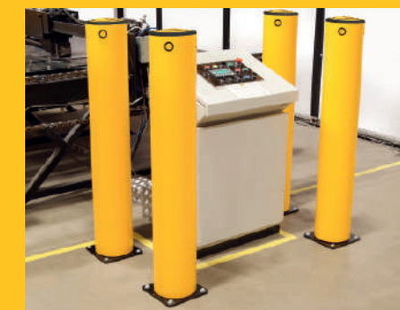
Dissuasori per la protezione di un pannello di controllo di una macchina semiautomatica in un'azienda di produzione.
