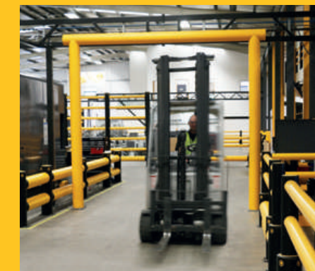
Protezioni Alte per la protezione di un impianto di aria compressa e cavi elettrici in un'azienda manifatturiera.
