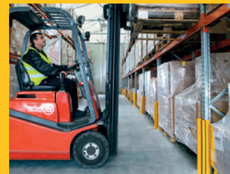
Protezioni montanti scaffale usati in un punto di impatto vulnerabile in un magazzino di packaging.
